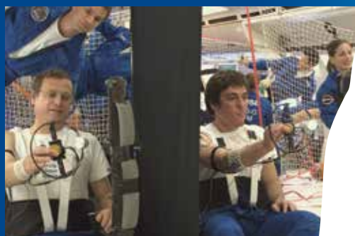
↑ Test du prototype GRIP au cours d'un vol parabolique recréant des conditions d'apesanteur
