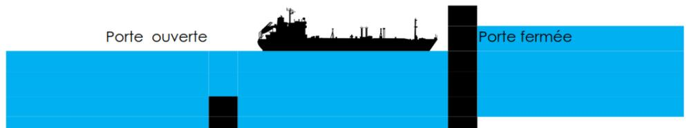
❸ On referme les portes aval. On fait monter l'eau dans l'écluse en ouvrant la vanne amont.
